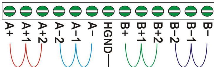
**四线制接法：**输入的 2 根高压线：A+1 为第一防区正极进线，A+2 必须跟 A+1 短接起来。A-1 为第一防区负极进线，A-2 必须跟 A-1 短接起来。B+1 为第二防区正极进线，B+2 必须跟 B+1 短接起来。B-1 为第二防区负极进线，B-2 必须跟 B-1 短接起来。
