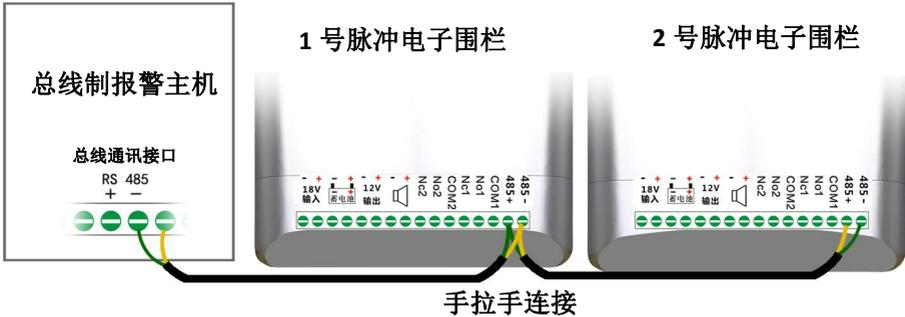
脉冲电子围栏主机与电子围栏键盘/总线制报警主机通过 485 总线手拉手串联，如上图所示。
