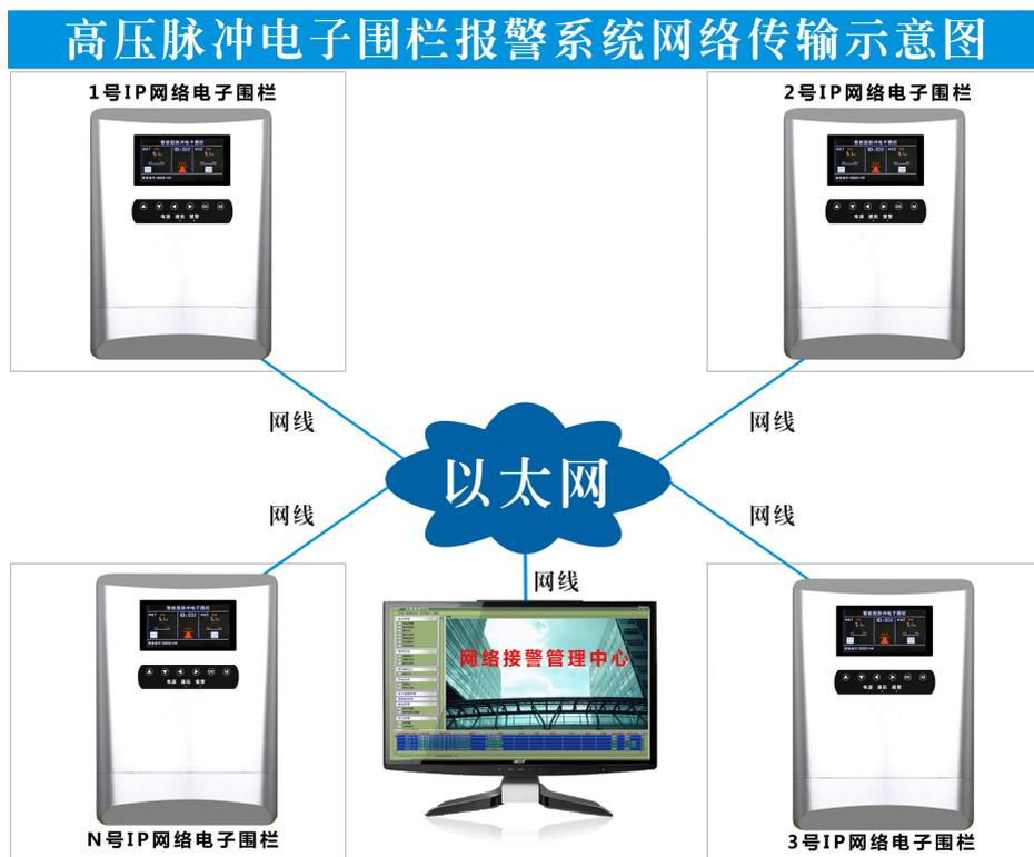
电子围栏主机可通过 RS485 转网络或 485 转光纤的方式，将报警系统传送至网络接警平台。通过网络需配备网络通讯模块，通过光纤需配备光端机。接警中心安装一套网络报警软件即可。通过网络报警软件可实现远程控制。同时可扩展其它设备，如电子地图模块，继电器联动输出模块，报警 LED 屏，声光喇叭等设备。通常适用于有网络或光纤的大型周界防范。
