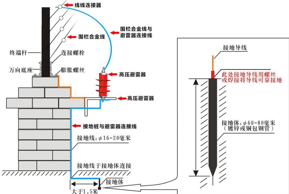
主机的上方，也可安装在墙体上，每一个防区都必须安装一个避雷器。
