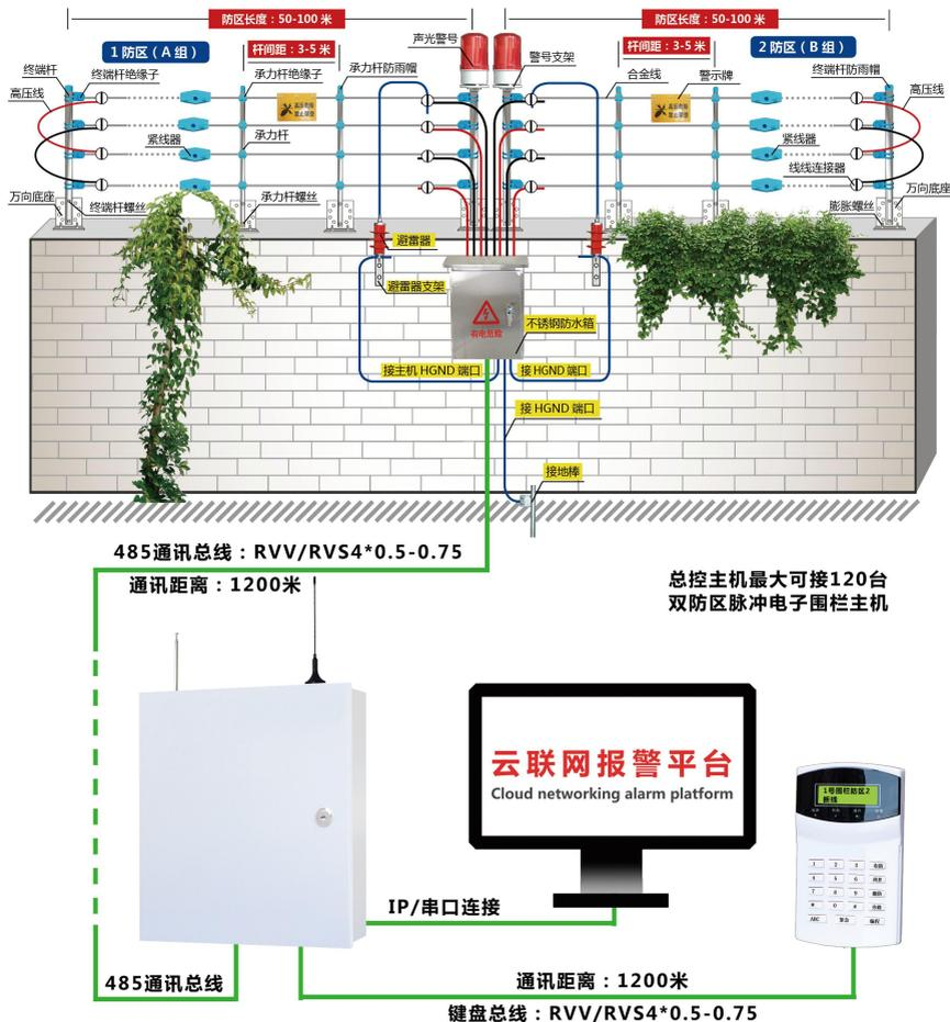
围墙高度应在 1.8M 以上，线杆的安装可以有焊接，卡箍或预埋三种方式，视围墙结构状况选择较合适的方式。例如，在铁栅围墙上，可采用焊接法；在混凝土围墙上，可采用预埋方式；在砖墙上可才用卡箍方式，只要能稳固没关系，也可采用别的方法。
