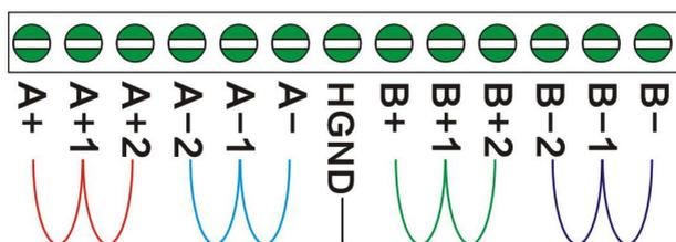
**2.5.3 六线制接法：**输入的 4 根高压线：A+1 A+2 为第一防区正极两根进线，A-1 A-2 为第一防区负极两根进线，B+1 B+2 为第二防区正极两根进线，B-1 B-2 为第二防区负极两根进线，HGND 接地。
