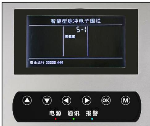
第一步：按 ▲ 键撤防，电压 0Kv
