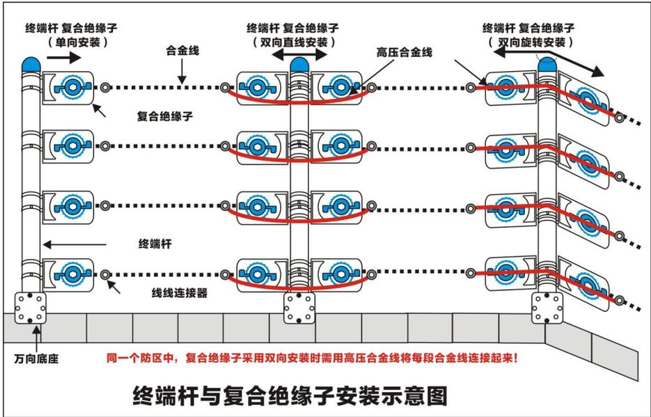
把终端杆绝缘子套在终端杆上，再用螺丝到把绝缘子上的螺丝拧紧，注意方向一致。考虑到距离越长，拉力越大，终端杆一般每 50m 或者大的拐角和分区处需安装。如果终端杆绝缘子采用双向安装方式，则终端杆绝缘子数量加倍，杆数量不变(如上图)。**承力杆安装方法与终端杆方法类似，也可以用终端杆替代。**
